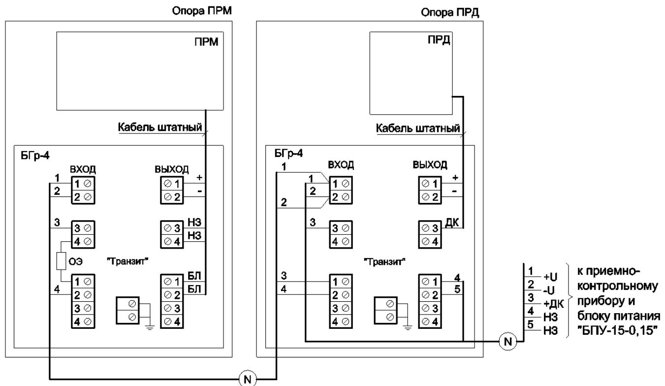
Подключение извещателя FMW-4 транзитом через приемник (через БГр-4)
