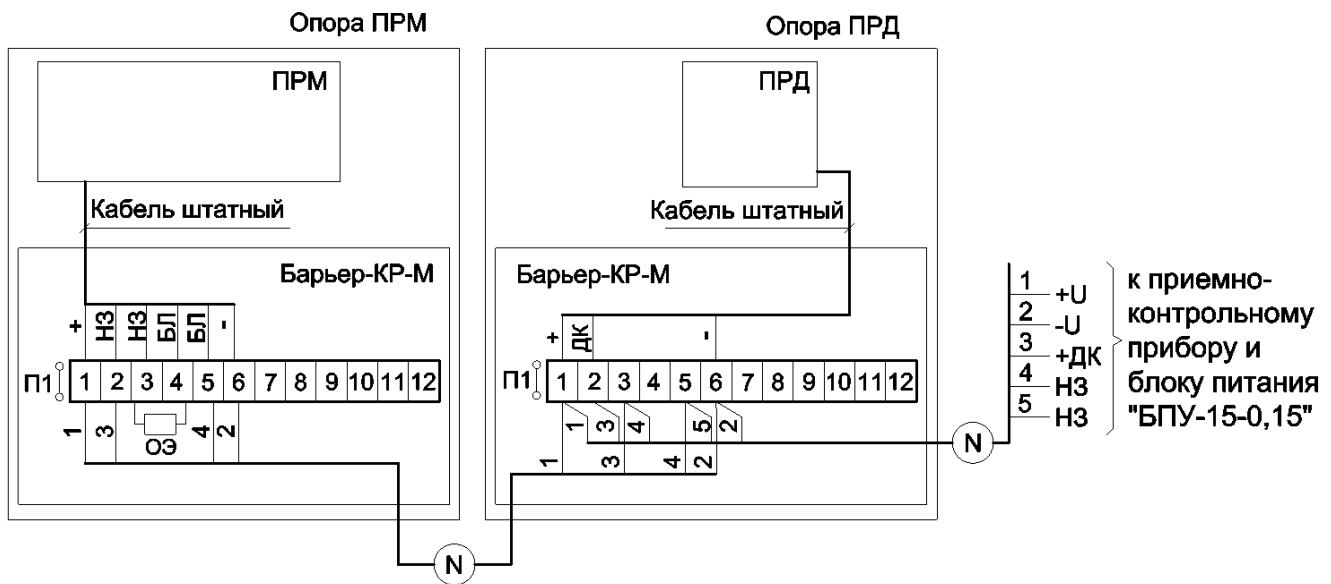
Подключение извещателя FMW-4 транзитом через приемник
