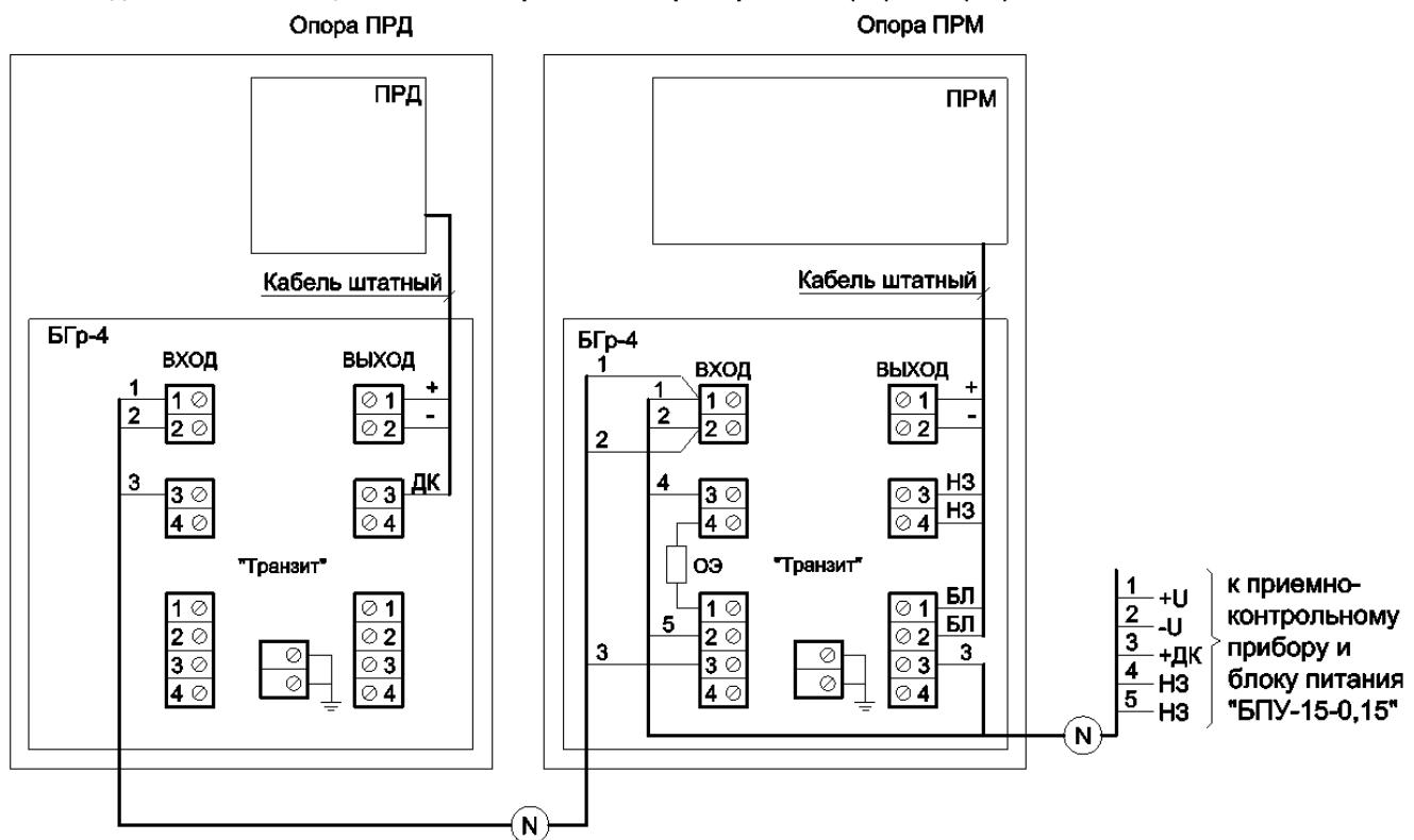
ОЭ – оконечный элемент приемно-контрольного прибора.
